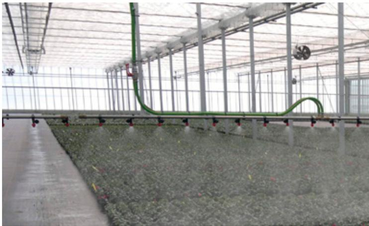
スプリンクラーシステムは、円を描きながら、重力によって散水します。このシステムには、デメリットが2点あります。散水される部分が重なってしまったり、不規則になってしまいます。また、傘のように水を受けてしまうシクラメンの葉の形状が、培養土への水の浸透を制限してしまいます。
